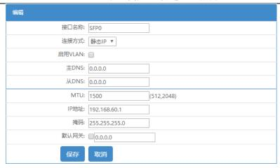
修改 VLAN, IP 地址,子网掩码,默认网关,DNS 地址等配置后,点击"保存"按钮进行参数保存。
